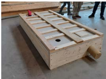
Holzrahmenelement mit sog. „Brille“, die einen Plattenbruch verhindert.
