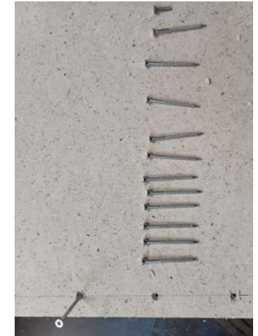
Zustand Nagelschrauben nach dem Heraus-schrauben
