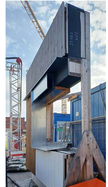
Fassadenmodell 1/1 (Mock-Up) als Vorbild für den Hauptversuch
