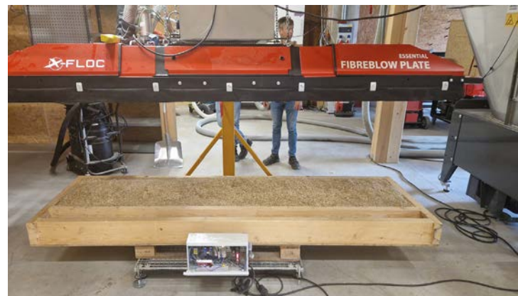
Erfolgreicher Versuch mit Einbringung von Strohdämmung mit einer Einblasplatte (Fa. X-FLOC)
