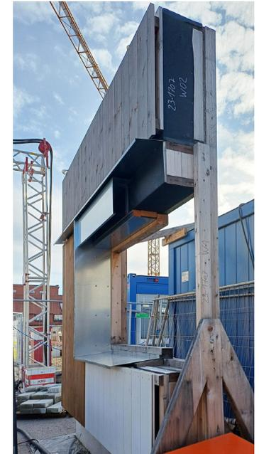
Fassadenmodell 1/1 (Mock-Up) als Vorbild für den Hauptversuch
